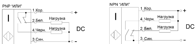
Рисунок 1 - Варианты схем подключения выключателей (цифрами указаны номера контактов)
