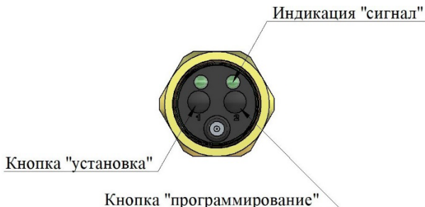
Рисунок 9 - Органы управления ДПУ для настройки режимов работы
