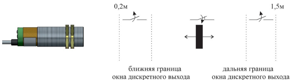
Рисунок 7 - Состояние дискретного выхода в режиме «НО»
