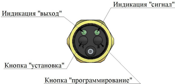
Рисунок 2 - Органы управления ДПУ
