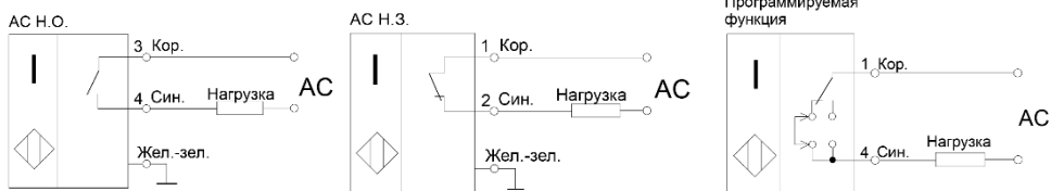
Рисунок 1 - Варианты схем подключения выключателей (цифрами указаны номера контактов клеммной коробки)
