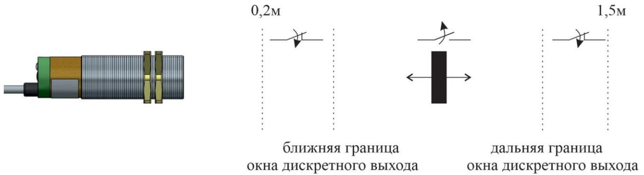
**Рисунок 7 - Состояние дискретного выхода в режиме «НЗ»**
