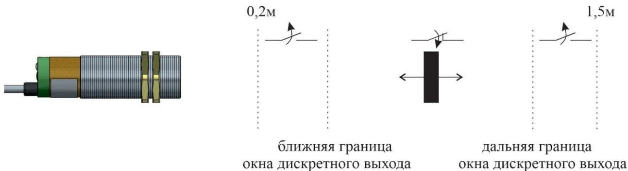
**Рисунок 6 - Состояние дискретного выхода в режиме «НО»**
