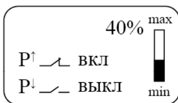
Рис.3 – Основное меню. Отображение информации об уровне заполнения и о состоянии реле
