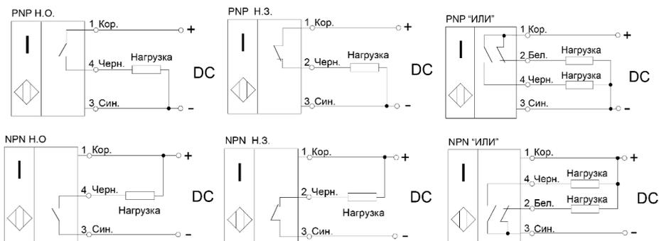
**Рисунок 1 - Варианты схем подключения выключателей**
