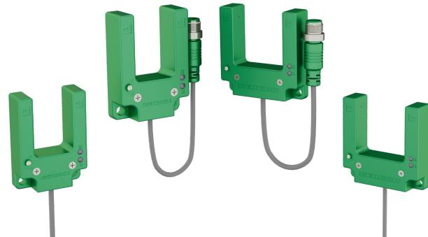
Щелевой оптический датчик представляет собой единый корпус. Имеет жёсткую вилочную конструкцию с двумя «плечами»: на одном расположен излучатель, на противоположном – приёмник. Между плечами образована щель (зазор), через которую проходит объект контроля. Объект обнаруживается при прерывании инфракрасного оптического луча в щели датчика. Срабатывание не зависит от цвета, прозрачности или отражающей способности объекта.
