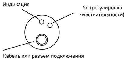
Рисунок 2 – Крышка корпуса у исполнений В, С, Р
