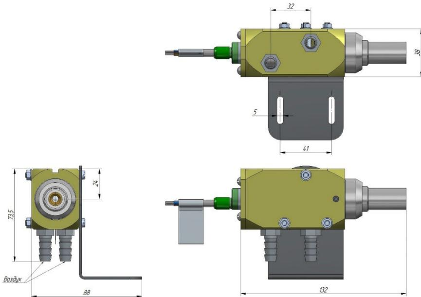
**Рисунок 1 - Внешний вид и габаритные размеры детектора**
