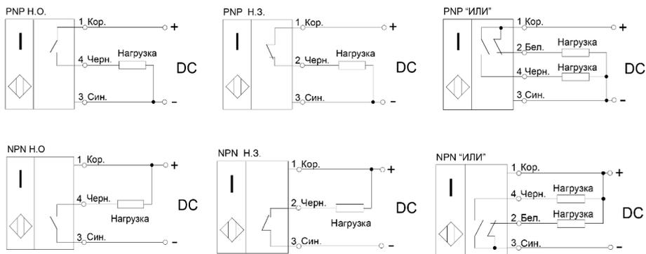
**Рисунок 1 - Варианты схем подключения выключателей**
