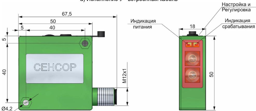
б) Исполнение Р - разъем М12 на корпусе
