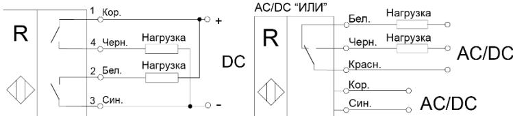
**Рисунок 3 - Варианты схем подключения выключателей**
