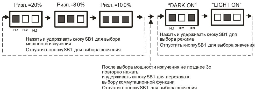
**Рисунок 4 - Работа индикаторов при настройке выключателей**
