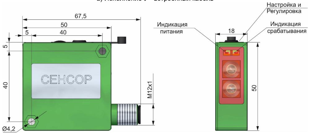
б) Исполнение Р - разъем M12 на корпусе
