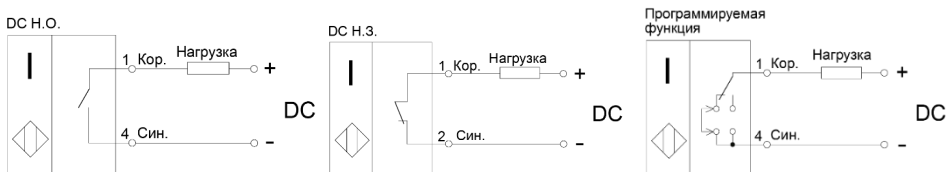
Рисунок 1 - Варианты схем подключения выключателей (цифрами указаны номера контактов разъема или клеммной коробки)
