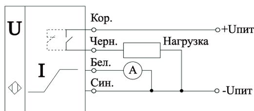
Рисунок 2 - Схема подключения ДПУ
