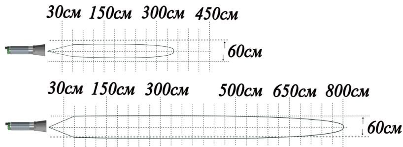
Рисунок 15 – Зона обнаружения ДПУ-М30-100У-8110-СА для небольших объектов (25x25мм) и крупных объектов (250x250мм)
