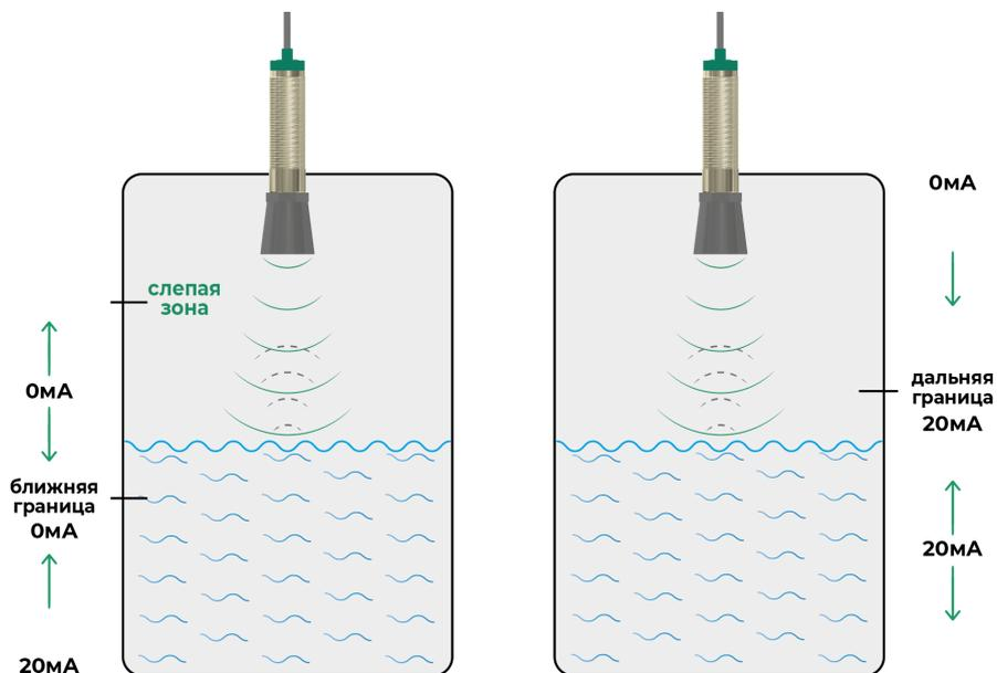
Рисунок 7 – значения выходного тока в режиме 0-20мА за ближней или дальней границами, режим - увеличение тока при удалении материала
