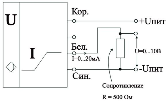
Рисунок 9 – Преобразование токового сигнала в сигнал по напряжению
