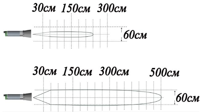
Рисунок 14 – Зона обнаружения ДПУ-М30-100У-5110-СА для небольших объектов (25x25мм) и крупных объектов (250x250мм)
