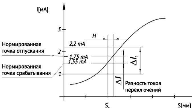
**Рисунок 2 - Зависимость тока датчика от расстояния срабатывания**
