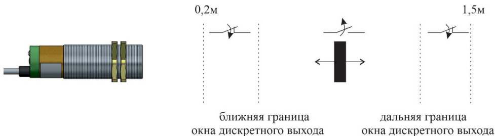
Рисунок 8 - Состояние дискретного выхода в режиме «НЗ»
