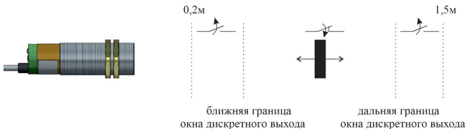
Рисунок 7 - Состояние дискретного выхода в режиме «НО»
