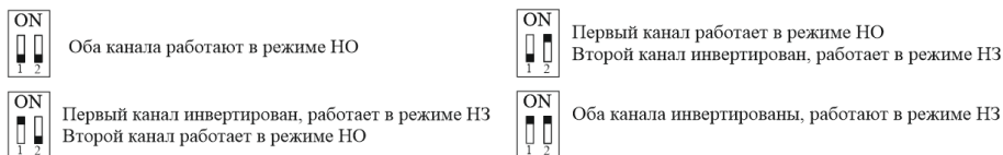
Рисунок 3 – Положения DIP-переключателя, режима работы каналов БИА
