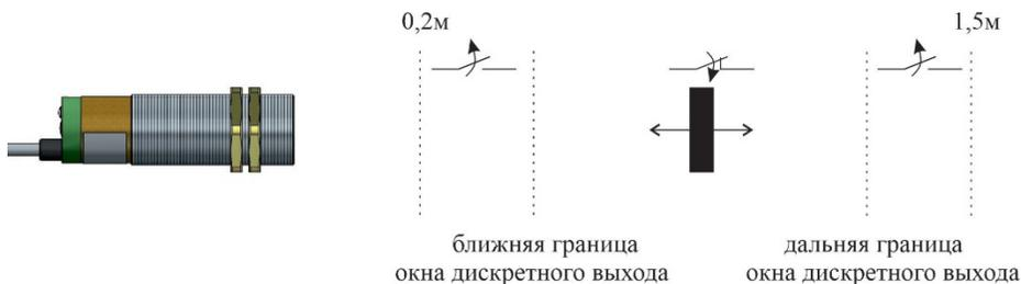
**Рисунок 7 - Состояние дискретного выхода в режиме «НО»**
