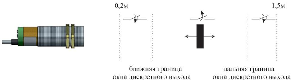
**Рисунок 8 - Состояние дискретного выхода в режиме «НЗ»**
