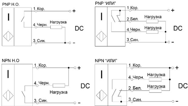
**Рисунок 3 - Варианты схем подключения выключателей**
