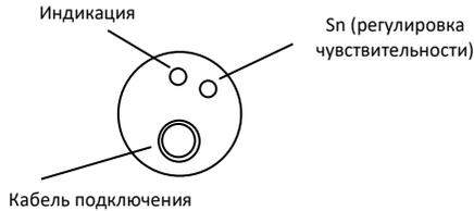
**Рисунок 2 – Крышка корпуса у исполнений В, С**
