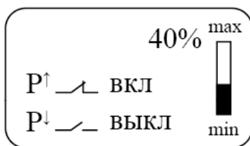
Рис.4 – Основное меню. Отображение информации об уровне заполнения и о состоянии реле
