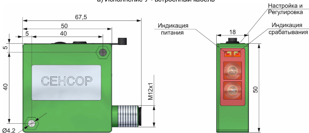
б) Исполнение Р - разъем M12 на корпусе
