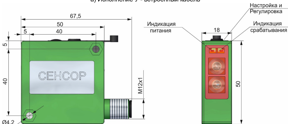
б) Исполнение Р - разъем M12 на корпусе
